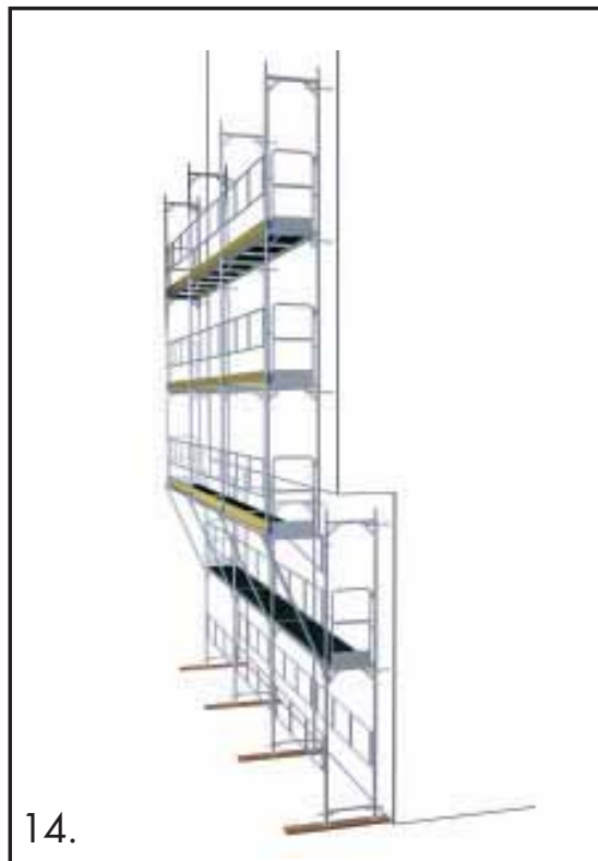
14. Ved fremskutt stillas skal konsollen SK 800 forsterkes med stag av galvaniserte rør SR 48, med vribare koplinger KV 48 x 48 til rett ovenfor rammen under, så nær toppen av rammen som mulig.
